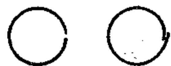
795. Сварка въ притыкъ. 796. Сварка въ нахлестку.
